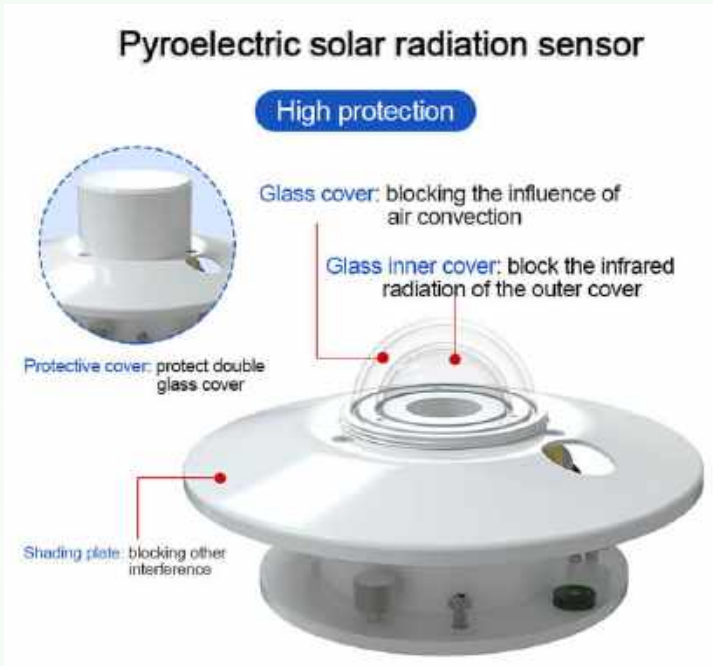
RS-TBQ-*-AL загварын гэрлийн мэдрүүр Гэрлийн мэдрүүрийн техникийн үзүүлэлт
